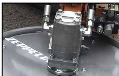
GIRO GRUPO CUCHILLAS MEDIANTE MOTOR HIDRÁULICO.
