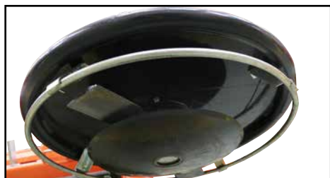
DISCO CON DOBLE CUCHILLA CON PROTECCIÓN PERIMETRAL Y PLATO ELEVADOR.
