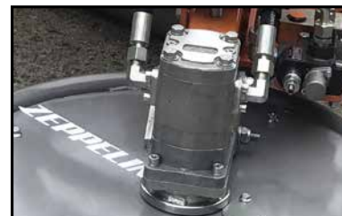
GIRO GRUPO CUCHILLAS MEDIANTE MOTOR HIDRÁULICO.
