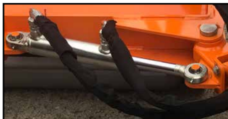
CILINDRO HIDRÁULICO PARA EL PLEGADO AUTOMÁTICO DEL BRAZO.
